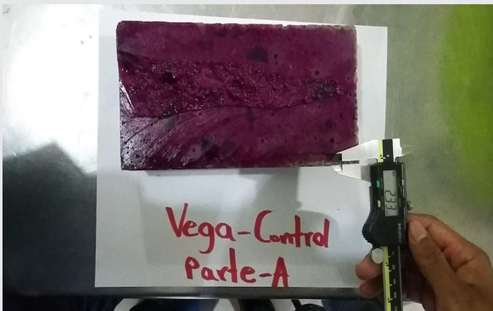
Imagen 3.3. Pruebas de carbonatación en mezcla de control de Vega de Alatorre mes de enero.
