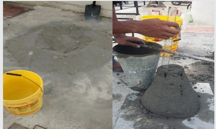
Imagen 2.3. Revenimiento de mezclas de concreto.
