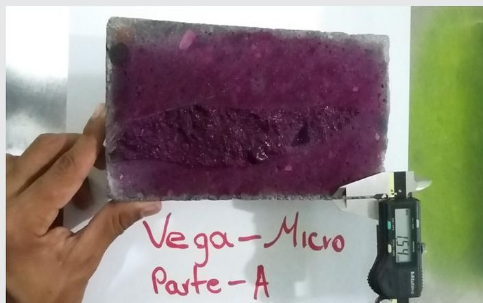
Imagen 3.5. Pruebas de carbonatación en mezcla con Microsilice de Vega de Alatorre mes de enero.
