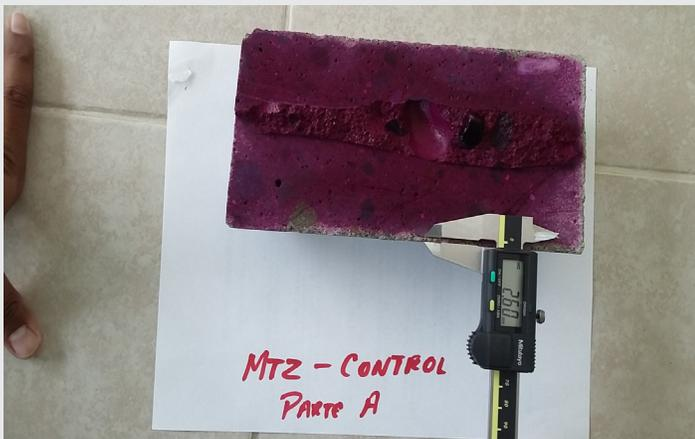
Imagen 3.2. Resultados de pruebas de carbonatación en mezcla control de Martínez de la Torre
