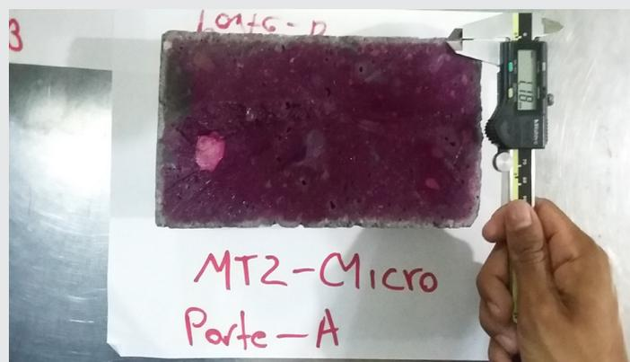
Imagen 3.6. Prueba de carbonatación en mezcla con Microsilice de Martínez de la Torre mes de enero. edio Control Vs Microsilice.
